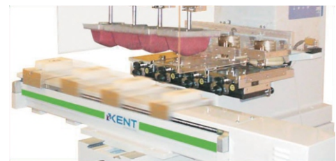
Lanzadera de alta velocidad: 1.200 mm / seg
